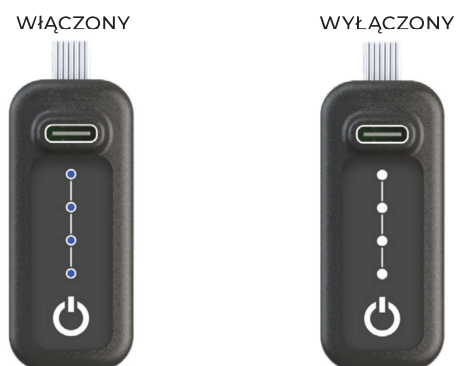
Rysunek. 7 Układ AET-CHR panelu z przyciskiem włącz/wyłącz i czterema diodami LED
